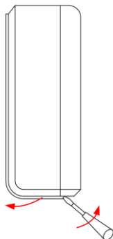
Рисунок 3 – Доступ к разъемам подключения, кнопке программирования и предохранителям (снятие крышки блока управления)
